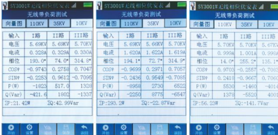
无线带负荷测试-10KV
